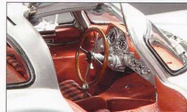
Exquisito interior con simil piel, tela y moqueta. Las puertas se mantienen alzadas gracias a los brazos articulados, idénticos a los originales.
