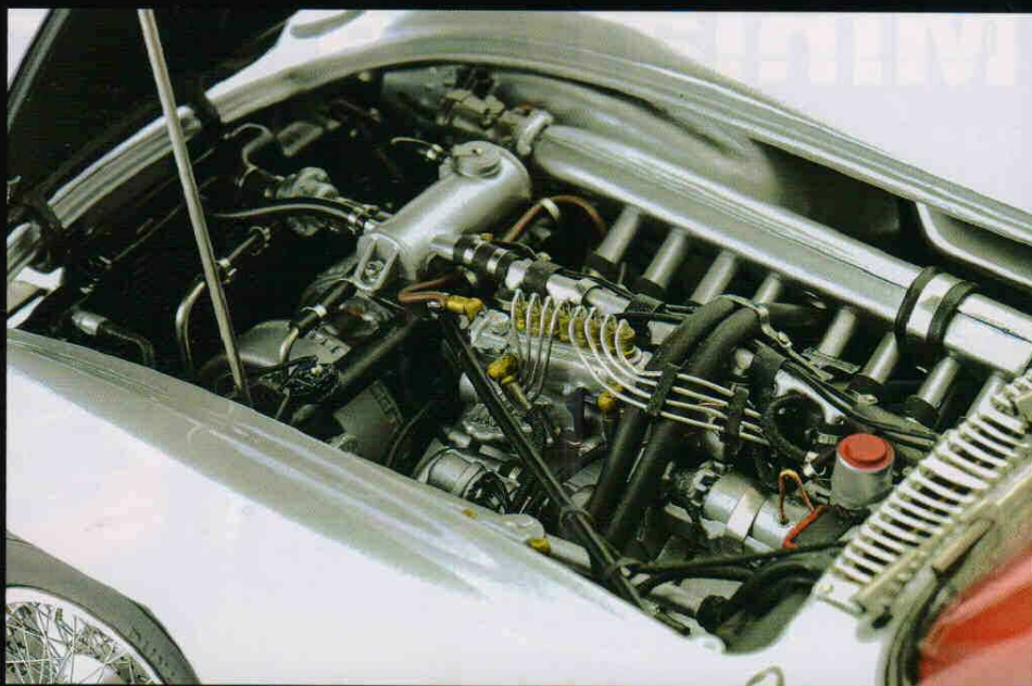
燃料噴射ポンプを備えた直列8気筒エンジンや、インボード・ブレーキの巨大なドラムなども再現されたエンジン・ルーム。
